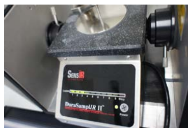
図 14. 固体試料プレスを用いた加圧の様子
