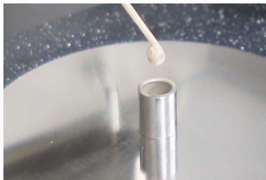
図 8. SC1 の ATR ユニットへの滴下 (続き)
