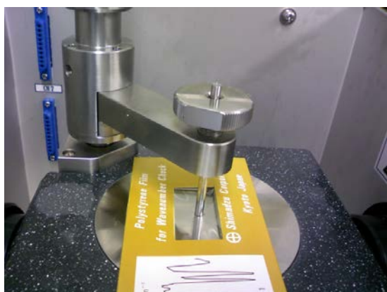
図 10. ATR ユニットへのポリスチレン・フィルムの取り付け
