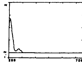
図9 中性溶液 (pH 7.3) 中のピリダリルの UV/VIS 吸収スペクトル
